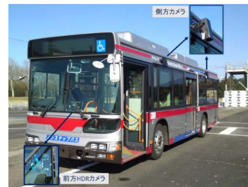
自動運転バスのためのTVカメラによる道路白線認識実験
